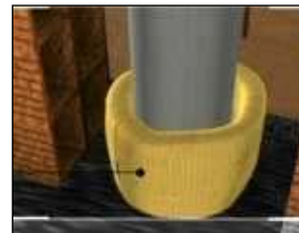
fasciatura tubazioni in corrispondenza dei solai
